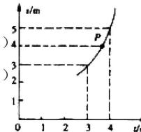
**【分析】**由题意知道物体做匀变速直线运动，根据平均速度的定义得到第4s的平均速度，根据位移时间图线上某点的斜率表示该点对应时刻物体的速度得到物体做加速运动，再根据运动学规律判断中间时刻速度和中间位置速度的关系。
