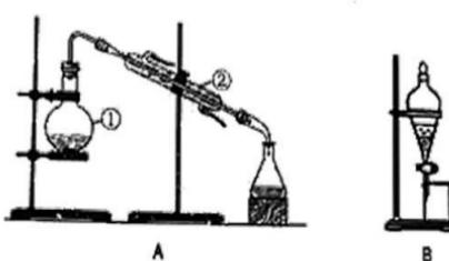
(1) A 图所示的操作名称是\_\_\_\_\_, 仪器②的名称是\_\_\_\_\_, 用此操作制取蒸馏水, 还缺少的一种仪器是\_\_\_\_\_, ①中加入少量碎瓷片的作用是\_\_\_\_\_, 将仪器补充完整后进行试验若试验过程中发现忘加碎瓷片, 应采取的正确操作是\_\_\_\_\_;
