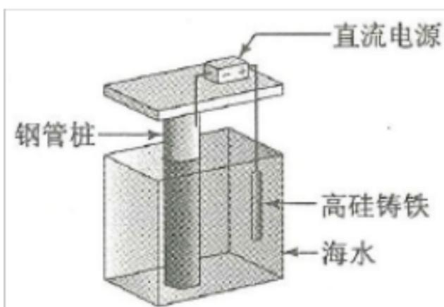
A. 通入保护电流使钢管桩表面腐蚀电流接近于零
