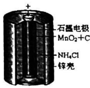
锌锰电池的构造
